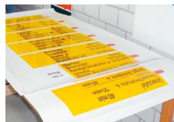
Fig. 21 Impression numérique: la poudre ou l'encre d'impression est appliquée sur un film. Ce dernier est ensuite collé sur les indicateurs de direction.
