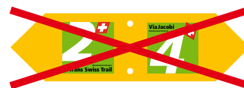
Fig. 27 Ne jamais placer deux champs d'itinéraire différents sur un indicateur de direction à deux pointes!
