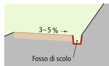
Fig. 30 Pendenza trasversale verso monte
