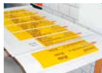
Fig. 21 Stampa digitale: si applica la polvere o l'inchiostro di stampa su una pellicola che si incolla sull'indicatore di direzione.
